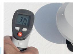
La temperatura de los escalones después de aplicar CoolDry ha descendido hasta los 31 °C.
